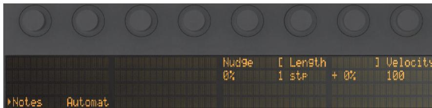
Mantenete premuto uno step per regolare i parametri della nota e dell'automazione.
