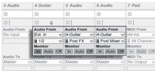
Un esempio di configurazione per Registrazione Post-Effetti.
